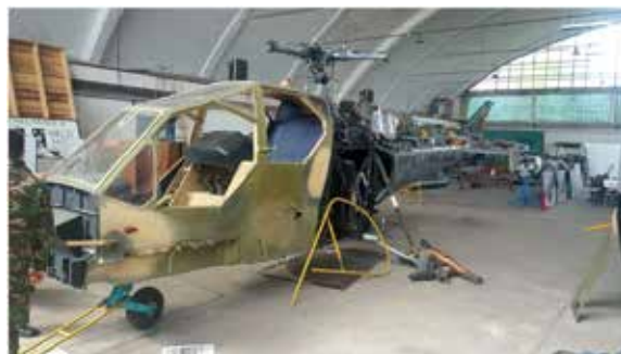
Elicopterul dezasamblat și pregătit pentru recondiționare
