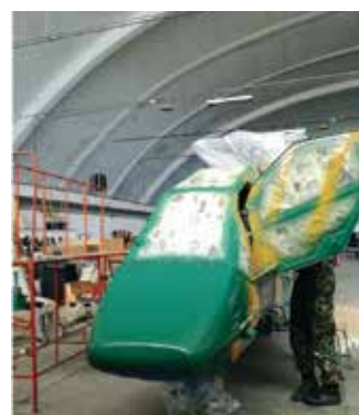
Aspecte din timpul recondiționării - vopsirea structurii fuzelajului și a cabinei
