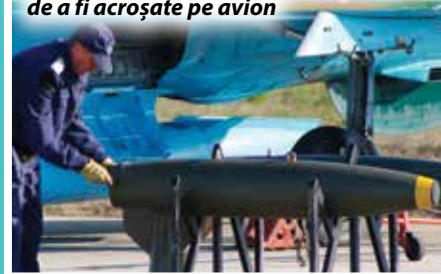
Pregătirea bombelor Mk 82, înainte de a fi acroșate pe avion
