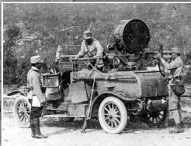
Tun antiaerian sistem Burileanu și proiector cu diametrul de 90 cm, două elemente de bază ale sistemului de apărare antiaeriană
