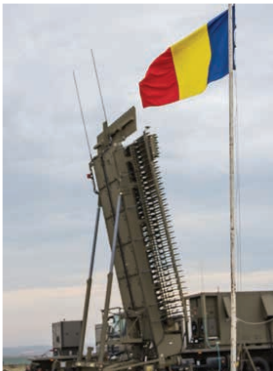
Radarele TPS-77 (foto sus) fac parte din familia de radare AN/FPS-117, radare aflate deja în înzestrarea Forțelor Aeriene; cele două tipuri de radar au configurații similare, ceea ce permite realizarea unui sistem de sprijin logistic comun, costurile de mentenanță și asigurare logistică fiind reduse semnificativ. Sistemul de rachete sol-aer PATRIOT (foto jos) reprezintă o îmbunătățire semnificativă a capacității de apărare a spațiului aerian național și a flancului estic al NATO
