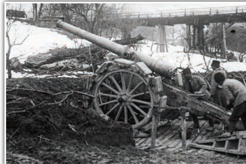
Tun antiaerian de calibru 75 mm special proiectat pentru trageri antiaeriene
