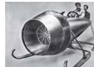
Prima sanie cu motor turboreactor, concepută și realizată de Henri Coandă în anul 1915
