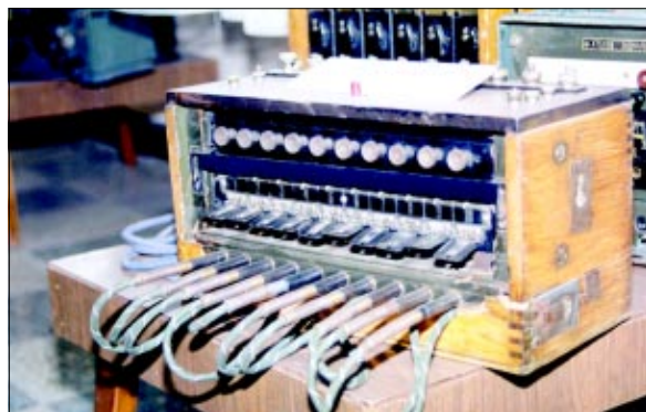
Centrală telefonică de 10 numere, devenită... istorie
