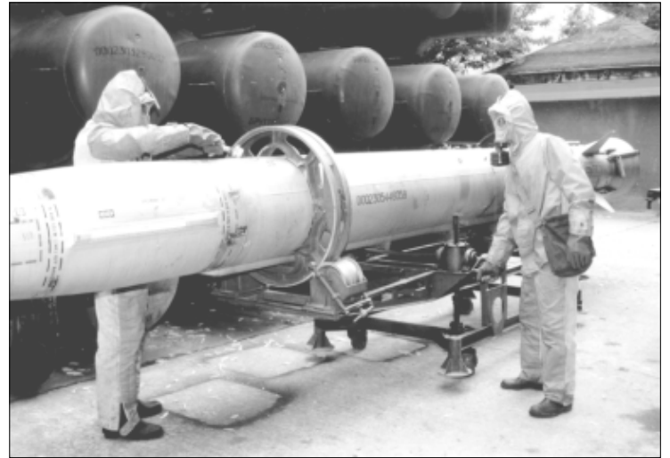
Cu oxidantul nu-i de glumă; alimentarea, golirea și neutralizarea rezervorului necesită atenție maximă din partea servanților și multă, multă îndemânare
